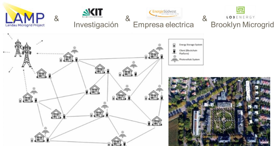
Figura 6. El Landau Microgrid Project: blockchain para comercio directo de electricidad
